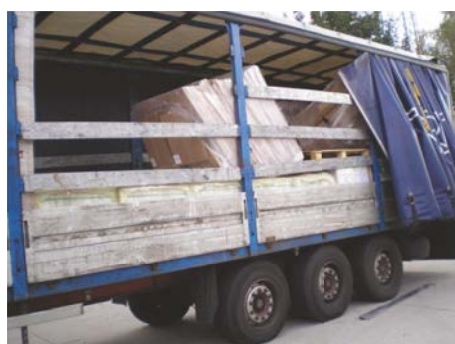
Figur 19: Utilstrækkelig fastgørelse af last udelukkende med strækfilm
