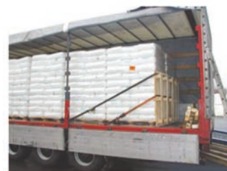
Figur 39: Fjederbelastet surring med paller
